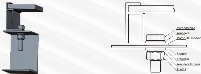
Figura 5 Instalación con pernos de un módulo mono facial
